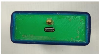
Le SAP est rechargé par la connexion USB. Si l'appareil est connecté lorsqu'il est éteint, il commence à se recharger. S'il est connecté alors qu'il est allumé, il ne se recharge pas. Mais si on l'allume pendant la charge, il continuera néanmoins à se recharger.
