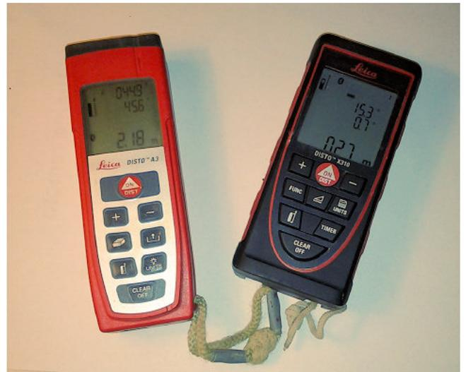
La calibration (pseudo-étalonnage) du DistoX nécessite de prendre 14 groupes de quatre clichés chacun, répartis dans toutes les directions. Les données de calibration sont ensuite téléchargées et les coefficients de pseudo-étalonnage sont calculés et transférés vers l'appareil.
